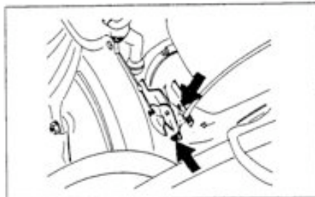
Bild 373 Bowdenzug Kaltluft einstellen
